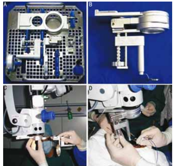
图2 BIOM3 组装过程 A:将 BIOM3 组件高温消毒;B:按图组装个部件;C:将 BIOM3 悬挂臂通过 Zeiss 显微镜下端的适配转接卡位固定在显微镜上;D:将显微镜移至手术区域,旋转 BIOM3 机械臂上的活动铰链,对好显微镜下视野即可行眼底手术操作。
