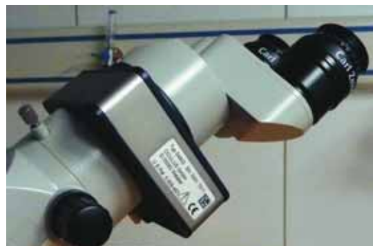
图3 立体倒像转换器组装至显微镜上,转换倒像。
