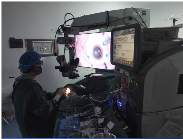
图1 3D手术视频系统手术过程 手术时移除手术显微镜光学目镜后原位安装 NGENUITY 3D 手术视频系统的图像采集模块,术者配戴偏光式3D眼镜,观察距离1.5m处55英寸3D显示器进行手术。
