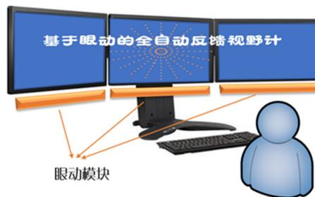
图1 基于眼动的全自动反馈视野计设计 中央为主显示器,两侧为辅助显示器,可根据模拟程序的不同决定是否选用,下方眼动模块为 Tobii TX300 眼动仪。
